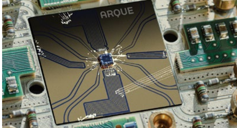
Abbildung 3: Quantenprozessor-Prototyp auf spezifisch entwickelter gedruckter Leiterplatte wie zur Demonstration des Transfers eines Spin-Quantenzustands über eine Distanz von 560 nm mit 99 % Erfolgswahrscheinlichkeit verwendet. © ARQUE Systems GmbH
