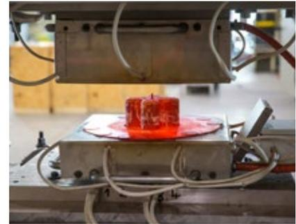
**Abbildung 2:** Das innovative Hot Forming kombiniert Umformung und Abschreckung in einem Schritt – ideal für hochfeste Leichtbaumaterialien mit anspruchsvollen Anforderungen die eine hohe Festigkeit bei gleichzeitig geringem Gewicht erfordern. (© HEGGEMANN AG)
