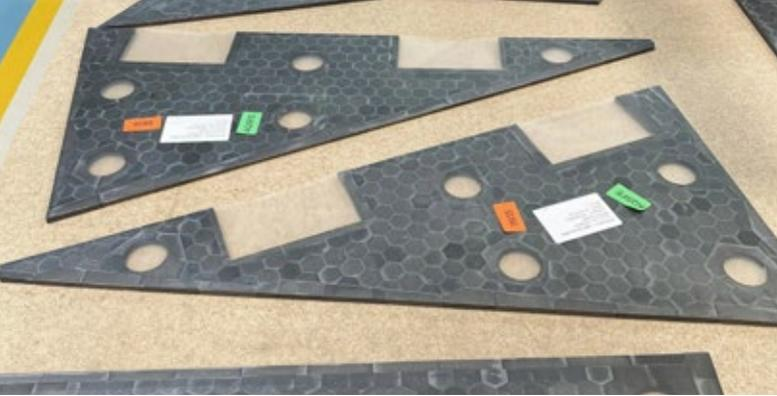
**Abbildung 1:** Bisher wurden Fahrzeuge meist mit Stahl oder Keramiklösungen aus Aluminiumoxid gepanzert. Steigende Schutzanforderungen und strikte Gewichtsvorgaben führen zunehmend zum Einsatz von anderen Hochleistungswerkstoffen wie gesintertes Siliziumkarbid (SSiC).
