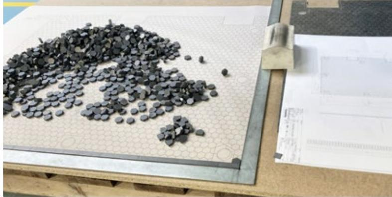
**Abbildung 2:** Maßgeschneiderte Komponenten in verschiedenen Geometrien und Designs bilden keramische Auskleidungen für die Panzerung von Militärfahrzeugen.
