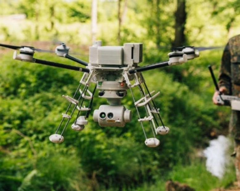
**Abbildung 1:** Die AR100-H Drohne von AirRobot im Flug über einem Waldgebiet. Mit ihrer kompakten Bauweise, hochauflösender Kamera und stabilen Quadrocopter-Technologie ist sie für taktische Aufklärung konzipiert. (© AirRobot)
