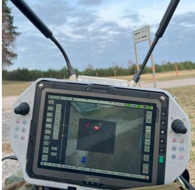
**Abbildung 2:** Im Vordergrund ist die AR-GCS (Bodenkontrollstation) des AR-100-H Aufklärungssystems zu sehen. Mit dieser lässt sich das Aufklärungssystem steuern, während gleichzeitig das Livebild der Drohnenkamera angezeigt wird, das in diesem Fall eine fusionierte Darstellung aus Tages- und Wärmebildaufnahmen eines Fahrzeugs aus der Vogelperspektive zeigt. (© AirRobot)
