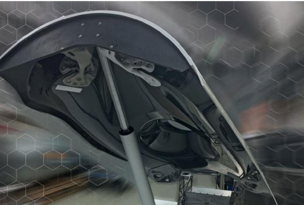
**Abbildung 1 (links): Airbrake** - Das DLR-Institut für Systemleichtbau hat eine neue faserverbund- und klebgerechte Bauweise anhand der Beispielkomponente der Airbrake des Eurofighters entwickelt. Mit den Partnern AIRBUS Defence and Space und dem Wehrwissenschaftlichen Institut für Werk- und Betriebsstoffe wurden hierfür neue Technologien zur Herstellung, wie CFK-Infusion und Kleben sowie 3D-Druck von Lasteinleitungs-komponenten erforscht. Credit: DLR (CC BY-NC-ND 3.0)
