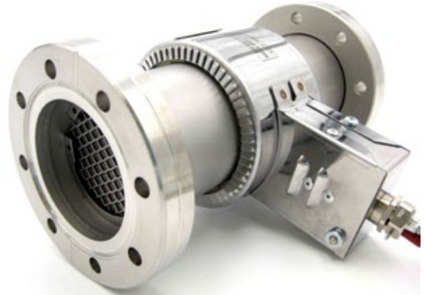
Abbildung 2: H 2 -Brenner NEO324 – flammenlose katalytische Oxidation für sichere H 2 -Restgasbehandlung © neoxid hydrogen AG
