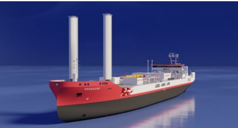
„Vanguard“: Die Animation zeigt das von HGK Shipping entwickelte fluss-seegängige Gastankschiff „Vanguard“. © HGK Shipping
