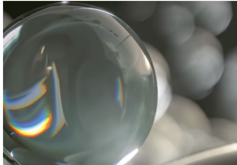
Glashohlkugeln von 3M sind einzeln betrachtet deutlich kleiner als die Spitze eines Streichholzes. Sie zeichnen sich durch eine geringe Wärmeleitfähigkeit und ein hohes Verhältnis von Festigkeit zu Dichte aus. Foto: 3M
