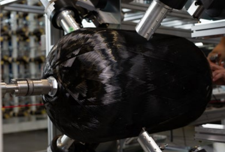
Abbildung 1: Multifilament-gewickelte Leichtbau Wasserstoffdrucktank: Vorimprägnierte Faser-Bänder werden präzise Lage für Lage auf einer Kunststoffblase abgelegt und bilden eine hochfeste, faserverstärkte Struktur für sichere und effiziente H 2 -Speicherung von über 700 bar. (© ITA)
