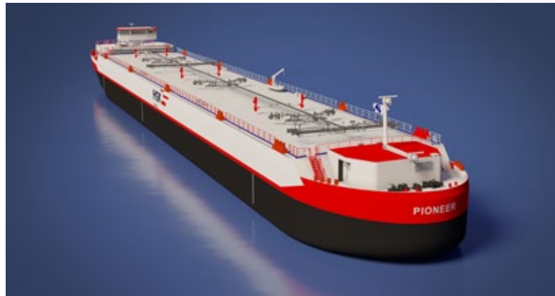
„Pioneer“: HGK Shipping treibt die Entwicklung von Europas erstem Gastankschiff für den Transport von kalt verflüssigtem Ammoniak und verflüssigtem Kohlenstoffdioxid in einem wegweisenden Pionierprojekt voran. © HGK Shipping
