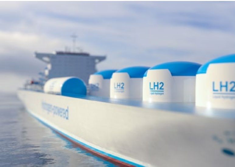
Die Lagerung von Wasserstoff erfolgt für gewöhnlich in doppelwandigen Tanks, mit einem mit Isoliermaterial gefüllten ringförmigen Zwischenraum. Foto: Shutterstock / 3M
